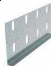
Применяется для соединения прямых секций лотков между собой. Поставляется в комплекте с метизами. Для монтажа лотков с высотой борта 40; 50; 65; 80 мм применяют соединитель РСЛ35. Комплектация метизами: болт М8х20 – 4 шт., гайка М8 – 4 шт., шайба 8 – 8 шт. Для монтажа лотков с высотой борта 100; 150; 200 мм применяют соединитель РСЛ100. Комплектация метизами: болт М8х20 – 8 шт., гайка М8 – 8 шт., шайба 8 – 16 шт.
