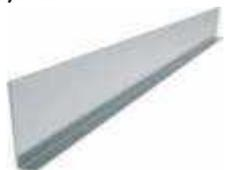
Применяется для разделения кабелей и линий с различным напряжением и функциями. Комплектуется четырьмя заклепками АЛ/СТ 4,0х12. Устанавливается на прямые секции лотков.
