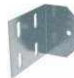
Применяется для монтажа прямой секции вертикально, для фиксации торца лотка опорной поверхности. Поставляется в комплекте с метизами. Для монтажа лотков с высотой борта 40; 50; 65; 80 мм применяют соединитель РСЛТ50. Комплектация метизами: болт М8х20 – 2 шт., гайка М8 – 2 шт., шайба 8 – 4 шт. Для монтажа лотков с высотой борта 100; 150; 200 мм применяют соединитель РСЛТ100. Комплектация метизами: болт М8х20 – 4 шт., гайка М8 – 4 шт., шайба 8 – 8 шт.
