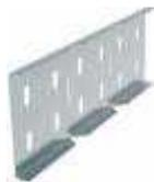
Применяется для соединения прямых секций лотков под произвольным углом в горизонтальной плоскости. Поставляется в комплекте с метизами. Высота соединителя углового СЛУ подбирается по высоте борта лотка. Для монтажа лотков с высотой борта 40; 50; 65; 80 мм. Комплектация метизами: болт М8х20 – 4 шт., гайка М8 – 4 шт., шайба 8 – 8 шт. Для монтажа лотков с высотой борта 100; 150; 200 мм. Комплектация метизами: болт М8х20 – 8 шт., гайка М8 – 8 шт., шайба 8 – 16 шт.
