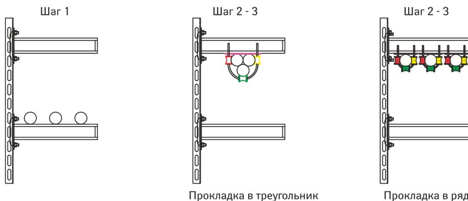
**\*Крепления кабеля на нижнем ярусе полок/консолей при помощи узлов крепления серии УКР не допускается.**
