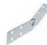
Применяется для соединения прямых секций лотков под произвольным углом в вертикальной плоскости. Поставляется в комплекте с метизами. Для монтажа лотков с высотой борта 40; 50; 65; 80 мм применяют соединитель РСЛШ50. Комплектация метизами: болт М8х20 – 4 шт., гайка М8 – 4 шт., шайба 8 – 8 шт. Для монтажа лотков с высотой борта 100; 150; 200 мм применяют соединитель РСЛШ100. Комплектация метизами: болт М8х20 – 8 шт., гайка М8 – 8 шт., шайба 8 – 16 шт.
